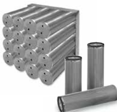
Filtr z węglem aktywnym Oddzielanie zapachów, zarazków i wirusów. Materiał wkładów: stal nierdzewna, blacha stalowa cynkowana, tworzywo sztuczne
