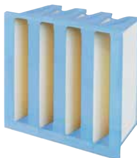
Filtr hybrydowy Filtr węglowy F7 z wkładem filtra aktywnego w kompaktowej obudowie do oddzielania substancji zapachowych i szkodliwych ( \text{NO}_x ) oraz cząstek o klasie filtracyjnej F7
